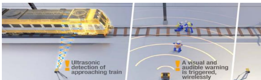
4 pav. „ATWS 3000“ perspėjimo sistemos veikimas
