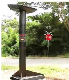
1 pav. „TAWS“ prietaisas ir veikimo schema (TAWS Train Approaching Warning)
