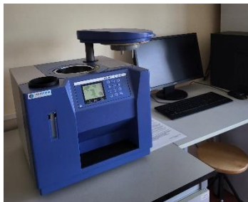
2 pav. Kalorimetras IKA C200
