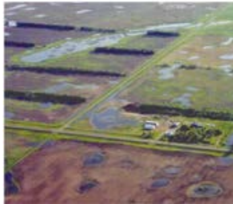
13 pav. Neveikiantis drenažas, galimos šlapynių susidarymo vietos
