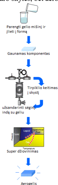
3 pav. Aerogelio gamybos schema
