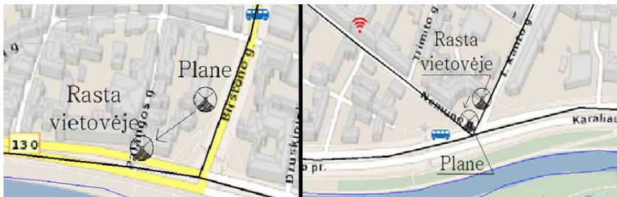
3. pav. Reperių padėties neatitikimas vietovėje ir plane [2]
